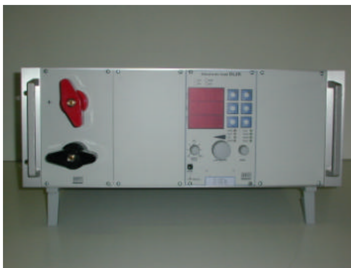
modello: DL18160 dimensioni L=485mm, H=180mm, P=465mm
